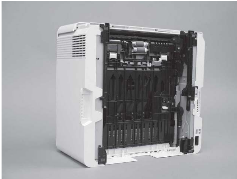
Figura 9-16 Coloque la parte inferior de la impresora hacia delante
